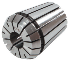
Spantang DIN 6499 ER Rondloop 0,01 - 0,015 mm geslepen en gehard
