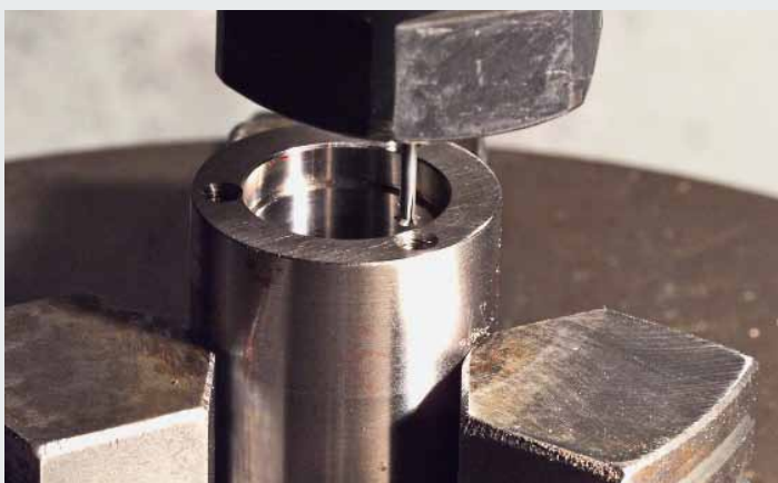
Der Einzahn-Gewindefräser hat einen Durchmesser von nur einem Millimeter.
